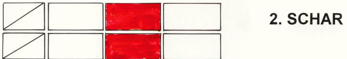
BEIM BLOCKVERBAND BEGINNT MAN IN DER LÄUFERSCHAR MIT SOVIEL LÄUFERDREIVIERTELER; WIE DIE MAUER AN KÖPFEN STARK IST.
