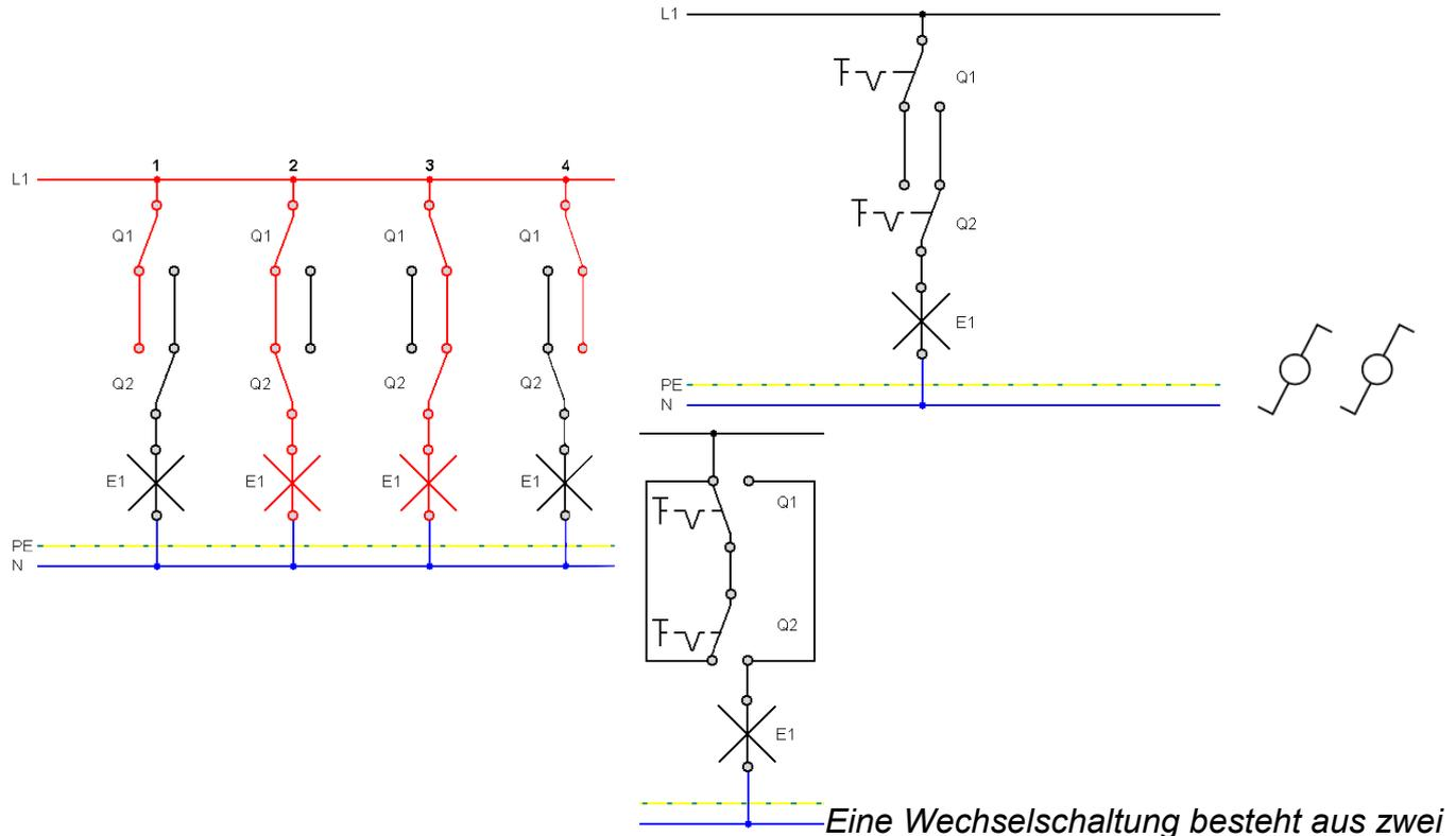
**Umschaltern.** Die Umschalter schalten den Strom von einem auf den anderen Kontakt. Insgesamt ergeben sich in einer Wechselschaltung vier verschiedene Schaltzustände.
